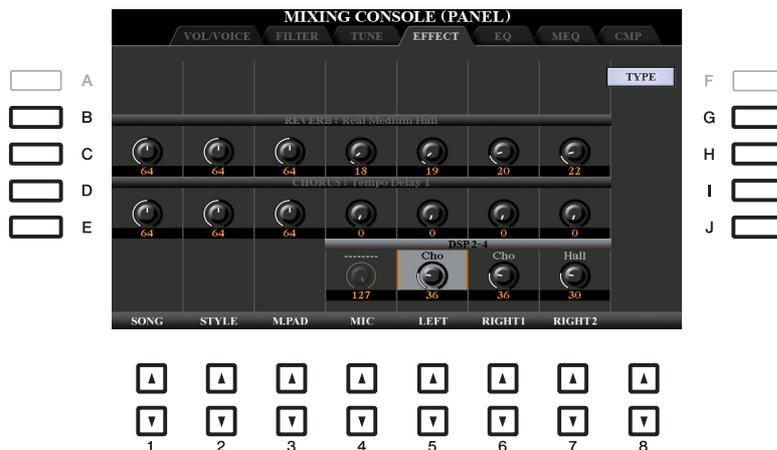
Utilice los botones [B]–[E] o [G]–[J] para seleccionar el bloque de efectos que desee y después utilice los botones [1 ▲▼]–[8 ▲▼] para ajustar la profundidad del efecto para cada parte.
